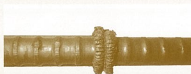
アプセット溶接部の一例
