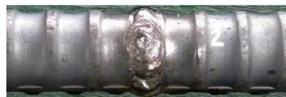
写真 1 JRJI 鉄筋溶接継手
