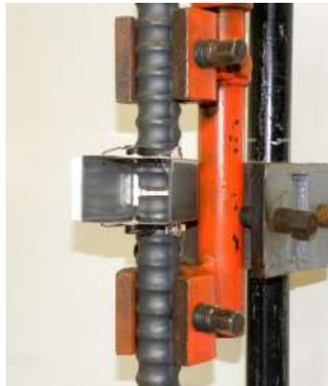
図 11. 横向溶接継手の溶接治具のセット状態
